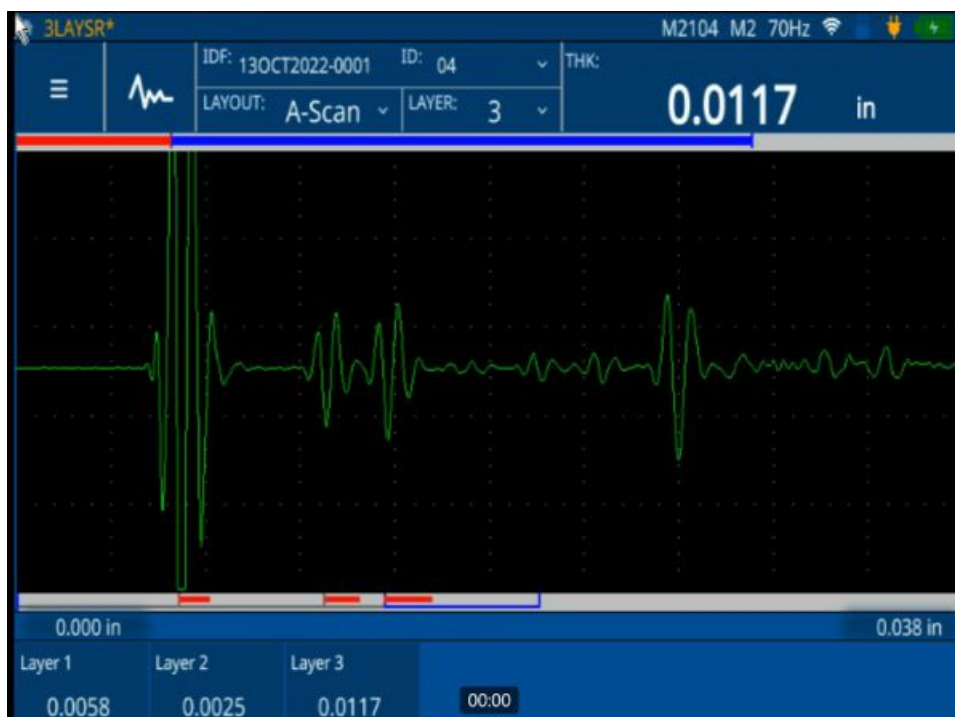
Medición de un recipiente de plástico de tres capas a 50 MHz usando un medidor de espesores ultrasónico 72DL PLUS
